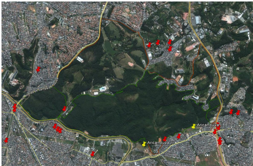
Figura 138. Piscinões Aricanduva II e III e os pontos de alagamento no entorno do PNMFC. Segundo a Prefeitura de São Paulo, esses piscinões são construídos em lugares estratégicos de forma a controlar as inundações nas mediações dos córregos presentes na capital paulista. Junto com a água são levados aos piscinões muito lixo e detritos, que acabam reduzindo a sua capacidade de armazenamento e fazendo com que os trabalhos de limpeza do seu interior e as manutenções sejam realizadas periodicamente, a fim de controlar esses efeitos advindos da poluição urbana 12 .
