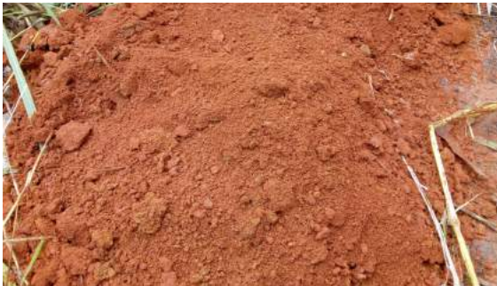
Foto 7.9 – Argila siltosa, pouco consistente, marrom avermelhado
