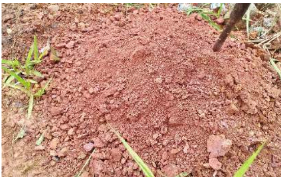
Foto 7.5 – Aterro, composto de silte argiloso, vermelho
