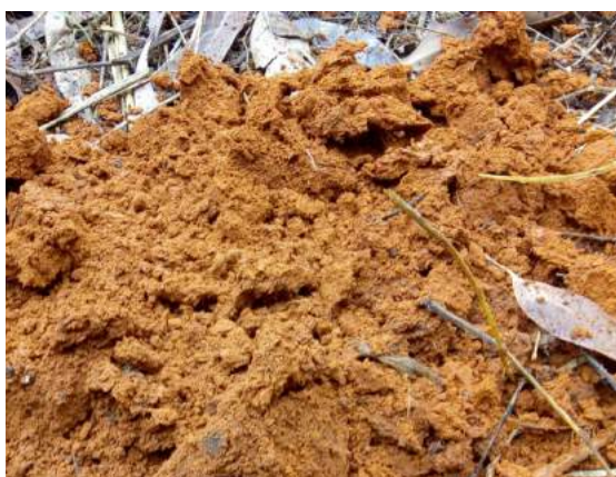
Foto 7.7 – Argila siltosa, medianamente consistente, marrom alaranjado. Ponto 5
