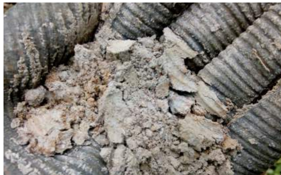
Foto 7.12 – Detalhae da argila siltosa, pouco consistente, marrom avermelhado
