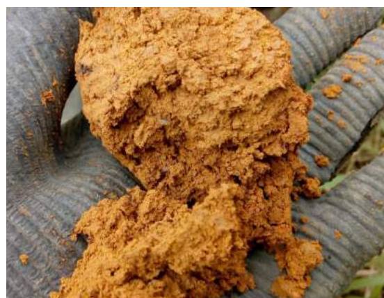
Foto 7.8 – Detalhe da argila siltosa, medianamente consistente, marrom alaranjado
