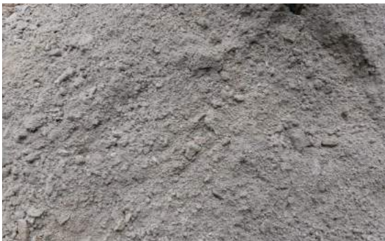
Foto 7.11 – Silte argiloso, seco, pouco consistente, cinza
