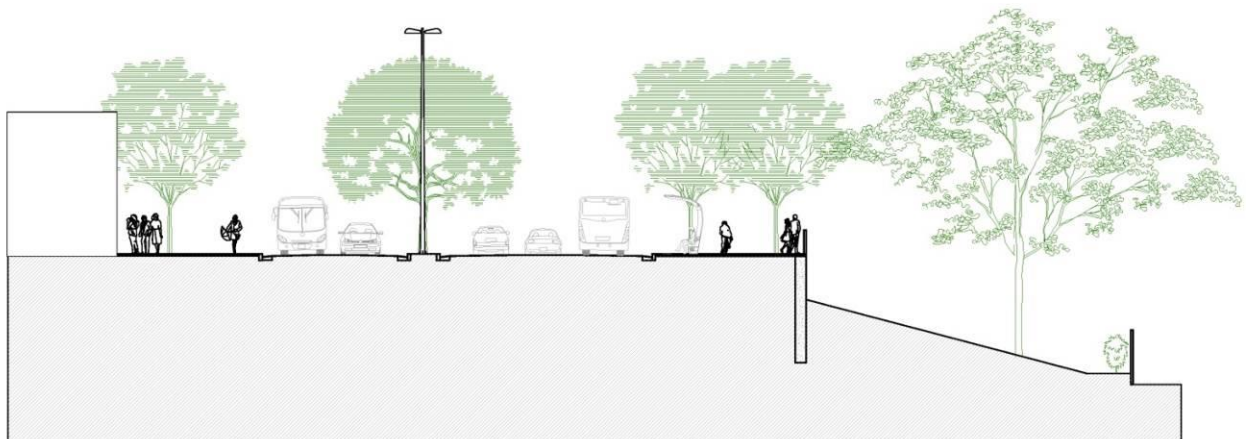
Figura 2.7.7-3 - Corte C-C' - Este corte está localizado, assim como o corte B-B', em uma área que terá desapropriação total e a implantação de um muro de contenção.
