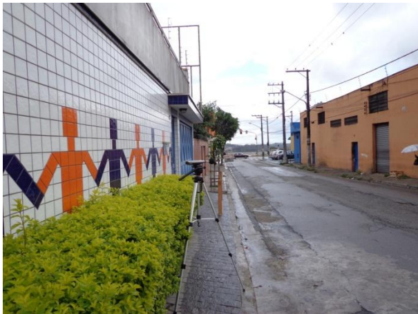
Foto 7.2.3-1 - Exemplo de posicionamento de aparelho utilizado para monitoramento dos níveis de ruído e vibração.
