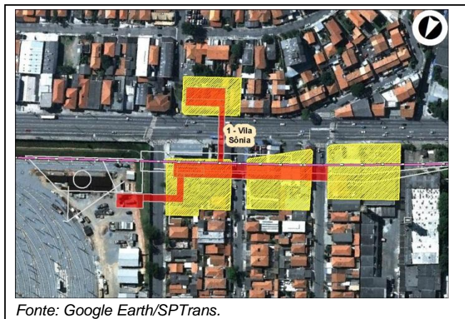
FIGURA 6.3-7 - ESTAÇÃO VILA SÔNIA: INTEGRAÇÃO COM A FUTURA ESTAÇÃO VILA SÔNIA DO METRÔ
