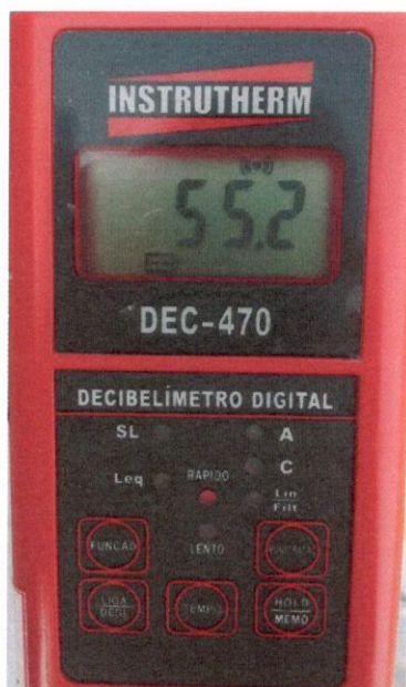
FOTO N° 27: Foto mostrando a medição de Leq = 55,2 \text{ dB(A)} realizada no Ponto 07 .
