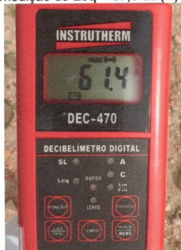
FOTO N° 34: Mostrando aqui a Medição de Max = 61,4 \text{ dB(A)} realizada no Ponto 09 .
