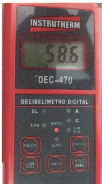
FOTO Nº 24: Foto mostrando a medição de Leq = 58,6 dB(A) realizada no Ponto 06 .
