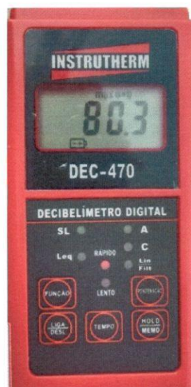
FOTO Nº 10: Medição de Max = 80,3 \text{ dB(A)} realizada no Ponto 01 .
