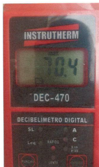
FOTO N° 22: Medição de Max = 70,4 \text{ dB(A)} realizada no Ponto 05 .
