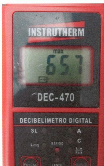
FOTO Nº 16: Mostrando aqui a Medição de Max = 65,7 \text{ dB(A)} realizada no Ponto 03 .
