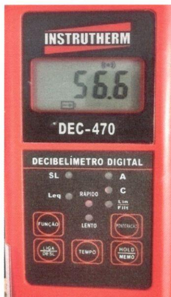
FOTO N° 39: Foto mostrando a medição de Leq = 56,6 \text{ dB(A)} realizada no Ponto 11 .
