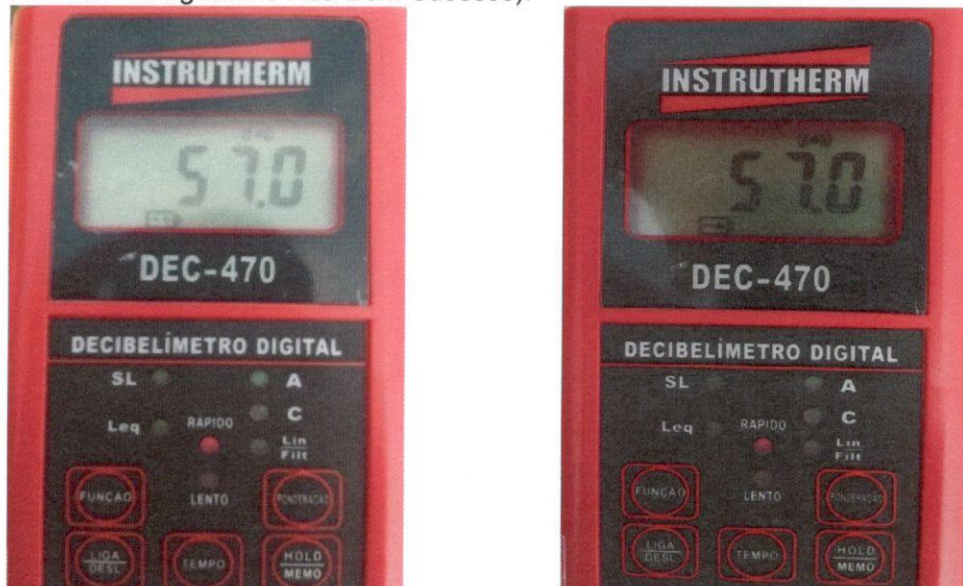
FOTO Nº 30: Foto mostrando a medição de Leq = 57,0 \text{ dB(A)} realizada no Ponto 08 .
