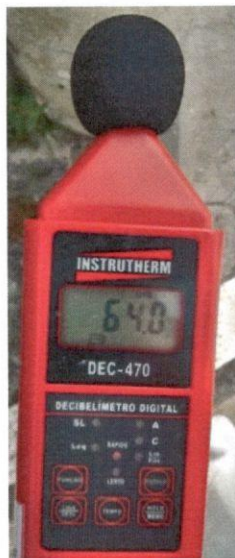
FOTO N° 21: Foto mostrando a medição de Leq = 64,0 \text{ dB(A)} realizada no Ponto 05 .
