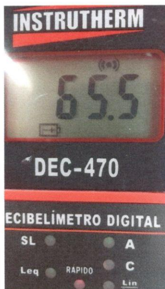
FOTO Nº 15: Foto mostrando a medição de Leq = 65,5 \text{ dB(A)} realizada no Ponto 03 .
