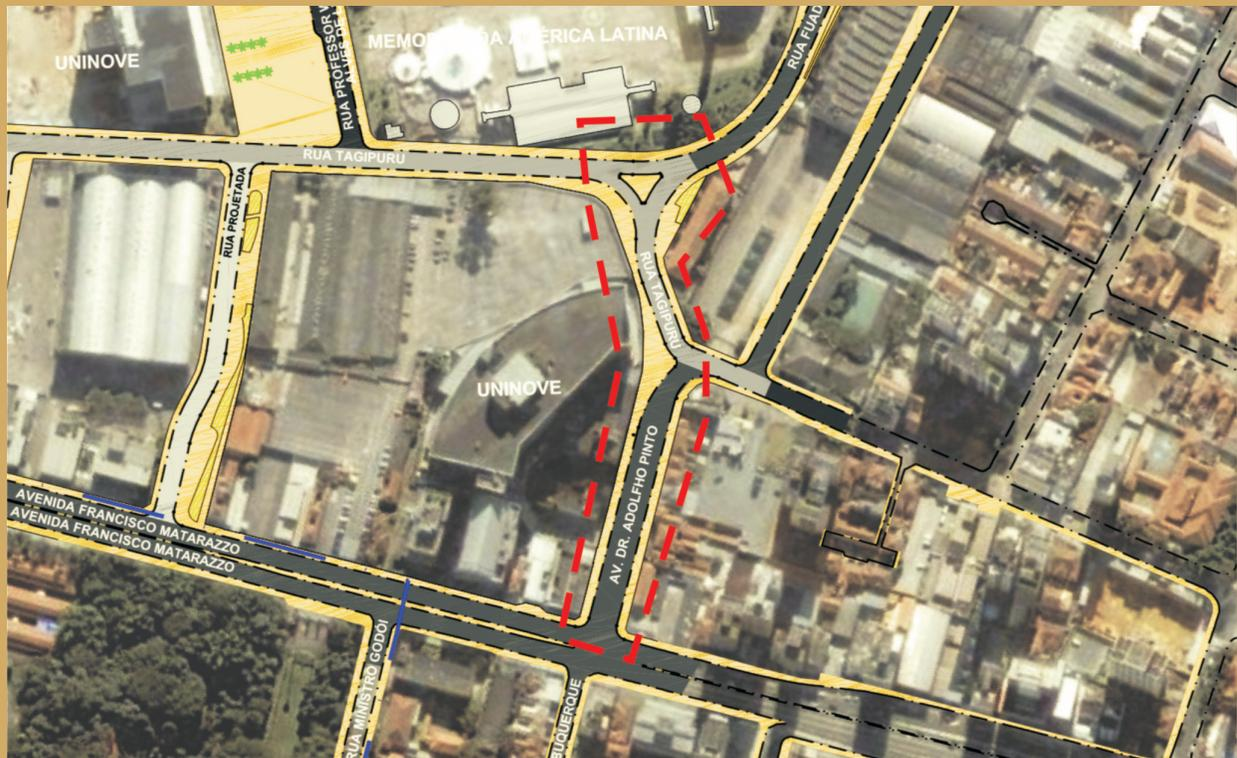
Fig 3.9: Reconfiguração geométrica rotatória da rua Dr. Fuad Nautel com rua Tagipuru
