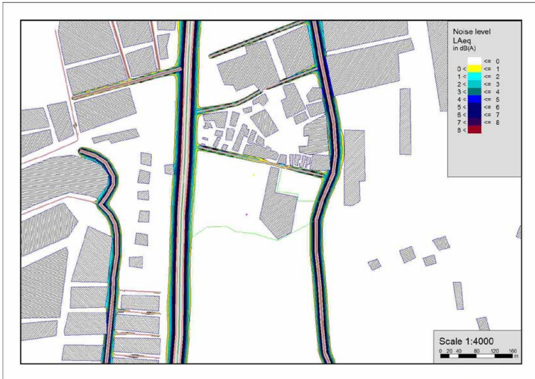
Figura 7.1.5.3-5: Acréscimo ao critério da Lei Municipal 13.885 (2004) devido ao nível de ruído ambiente diurno simulado no software SoundPlan 7.3
