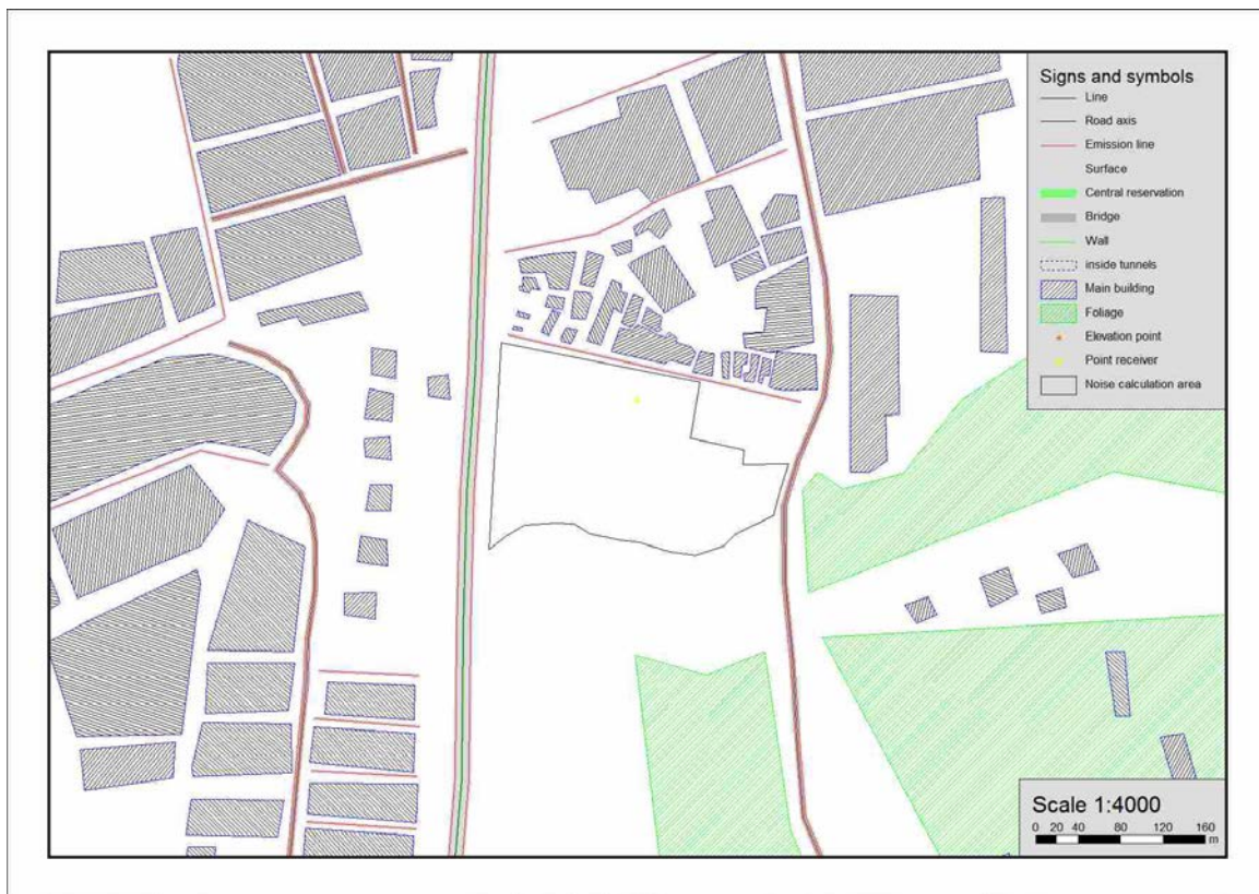
Figura 7.1.5.3-2: Modelo topográfico montado no software SoundPlan 7.3 para análise dos dados
