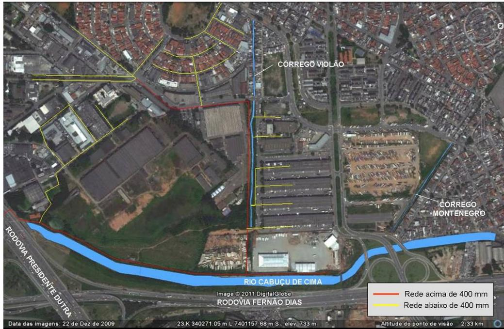
**Figura 2.3-15 – Rede de coleta de esgoto sanitário (em vermelho e amarelo).**
