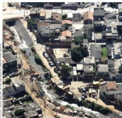
Antes da obra, o córrego Ponte Baixa estava em processo de assoreamento, o que intensificava as enchentes. A retificação e canalização exigiram o afastamento das edificações, com consequentes desapropriações ao longo de todo o trecho, dando origem à Avenida Luiz Gushiken
