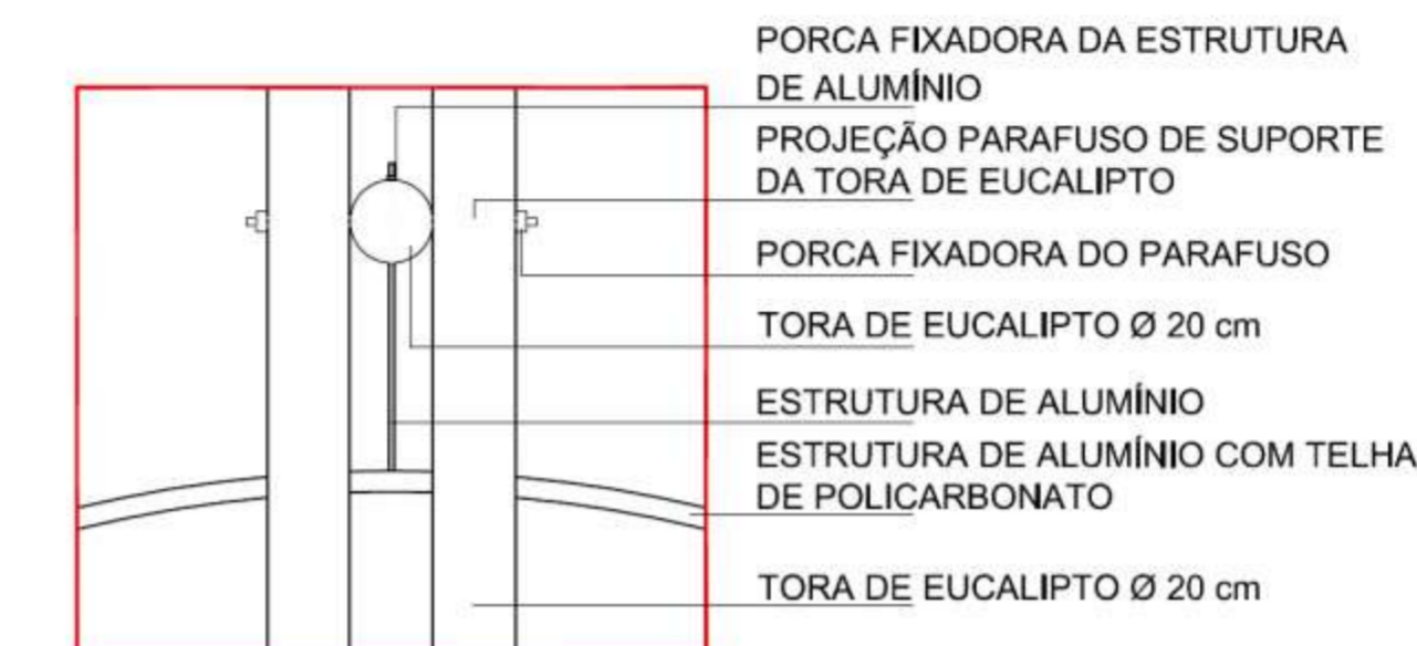
AMPLIAÇÃO ESTRUTURA PORTAL
