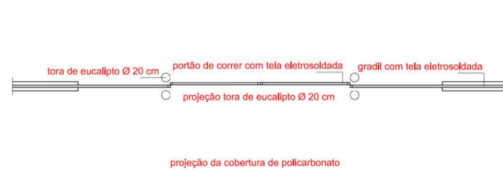
PLANTA DETALHE PORTAL DE ACESSO ESCALA 1:50
