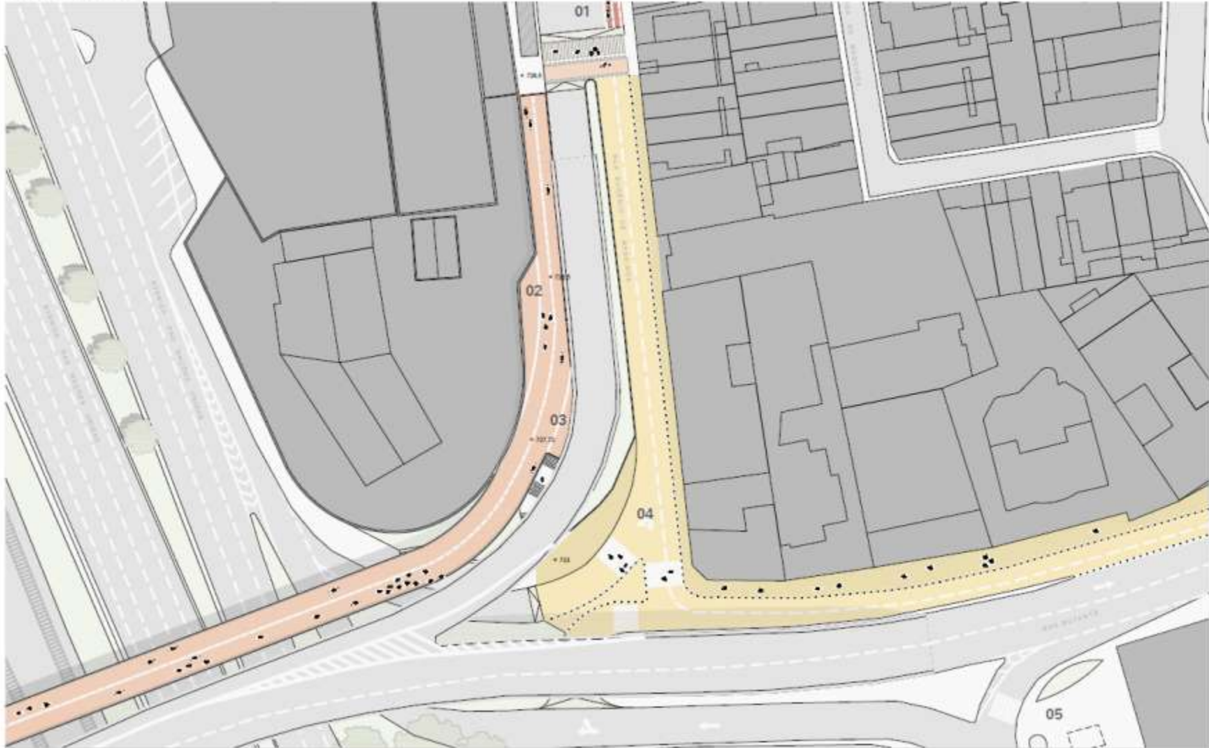
01. CICLOVIA PROPOSTA 02. ACESSO À CICLOPASSARELA 03. ACESSO ESCADA 04. VIA COMPARTILHADA 05. ACESSO À PASSARELA
