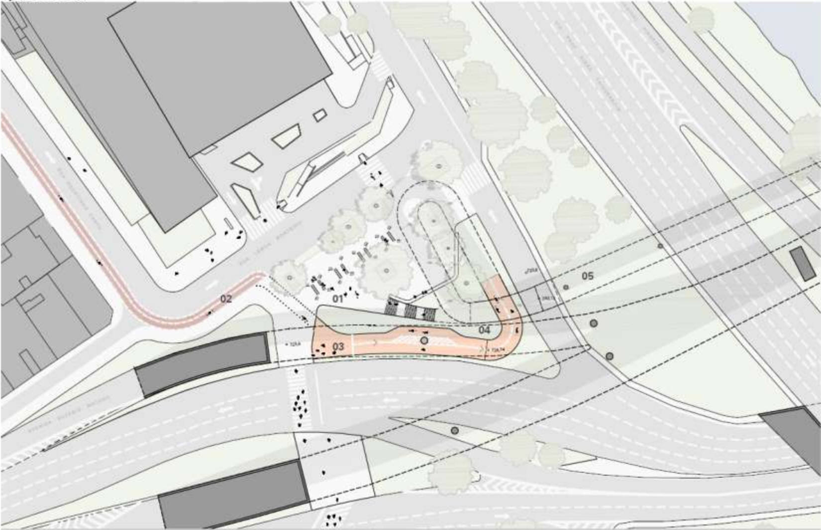
01. PRAÇA OLIVEIRA PENTEADO 02. CICLOVIA PROPOSTA 03. RAMPA DE ACESSO 04. TALUDE DE PROTEÇÃO 05. EIXO TRANSPOSIÇÃO
