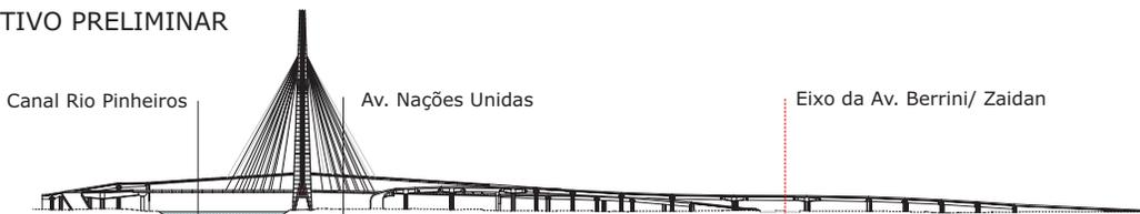
Os trechos em estrutura convencional, foram arranjados em 56 vãos, de maneira que a superestrutura em concreto, compostas por vigas pré-moldadas de 2,15 m de altura e as lajes, pudessem trazer homogeneidade com o trecho estaiado. Para os vãos superiores a 35 m, serão utilizadas vigas pré-moldadas protendidas, também com 2,15 m de altura, que serão apoiadas em estruturas com balanços, denominadas de vigas-caixão.
