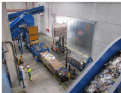
TMB – segregação das embalagens e biodigestão seca dos orgânicos
