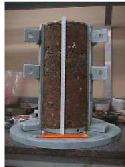
Figura 5.33: Desmoldagem do corpo-de-prova
