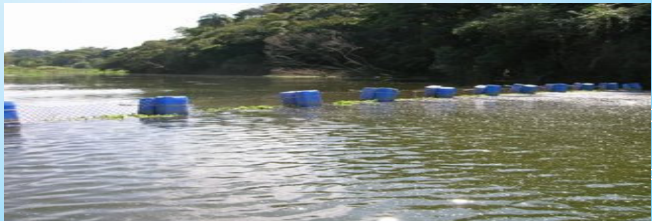
Ecobarreira em teste no córrego Guavirituba
