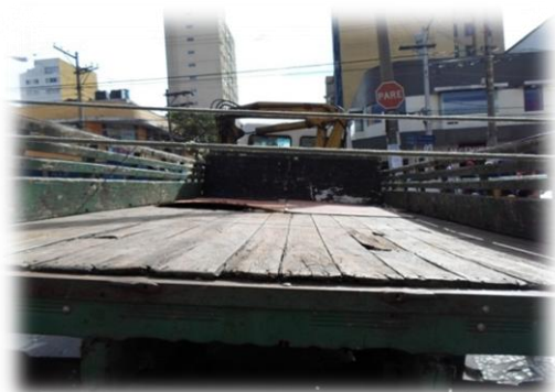
Foto 17: Piso da Carroceria possui “buracos” os quais estão cobertos com tapumes.
