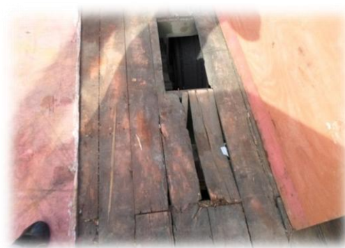
Foto 18: Piso Carroceria do Caminhão sem os tapumes.
