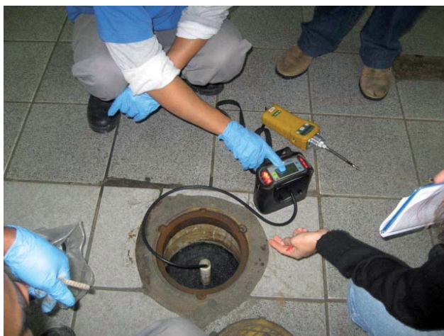
Figura 40 – Medição de metano realizadas em um dos poços de monitoramento dentro da área das escolas EMEI e EMEF
