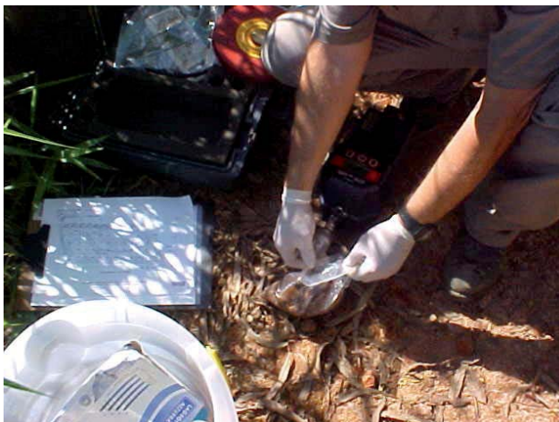
Figura 38 – Coleta de uma das amostras de solo realizadas durante as investigações ambientais
