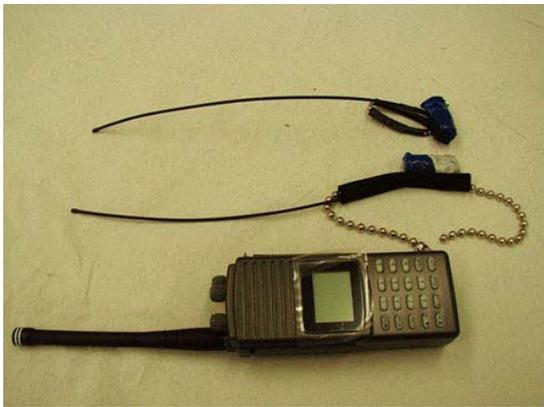
Foto 13 – Equipamentos de radiotelemetria: radiocolares e aparelho receptor.
