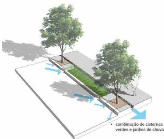
FIGURA 11.5-2 - ESQUEMA DE FUNCIONAMENTO DO JARDIM DE CHUVA
