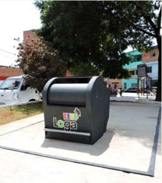
Nas fotos acima, o sidetainer da Av. Faria Lima, com capacidade para 3,2 mil litros. Abaixo, o bigtainer instalado no Recanto dos Humildes, em Perus, com seus 20 mil litros de capacidade.
