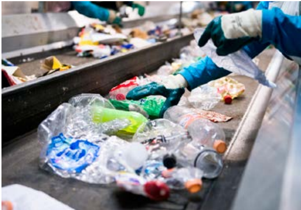
9 Plásticos seguem em uma esteira e é feita uma separação manual final para descartar detritos não aproveitáveis que ainda tenham restado no processo.
