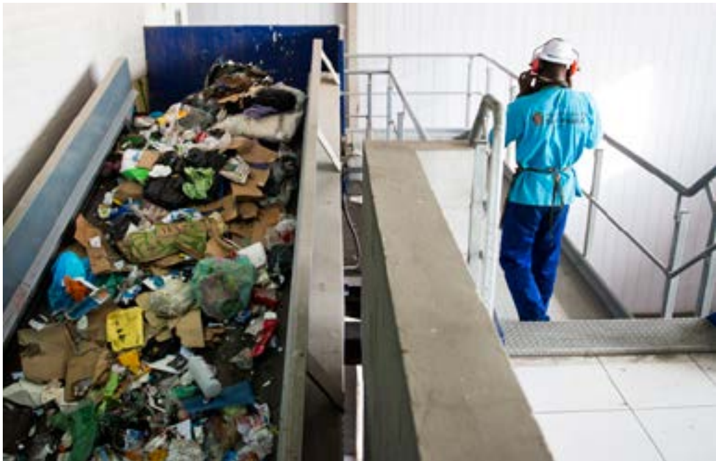
3 Após a descarga o resíduo é levado a uma primeira separação por funcionários por meio de uma esteira.
