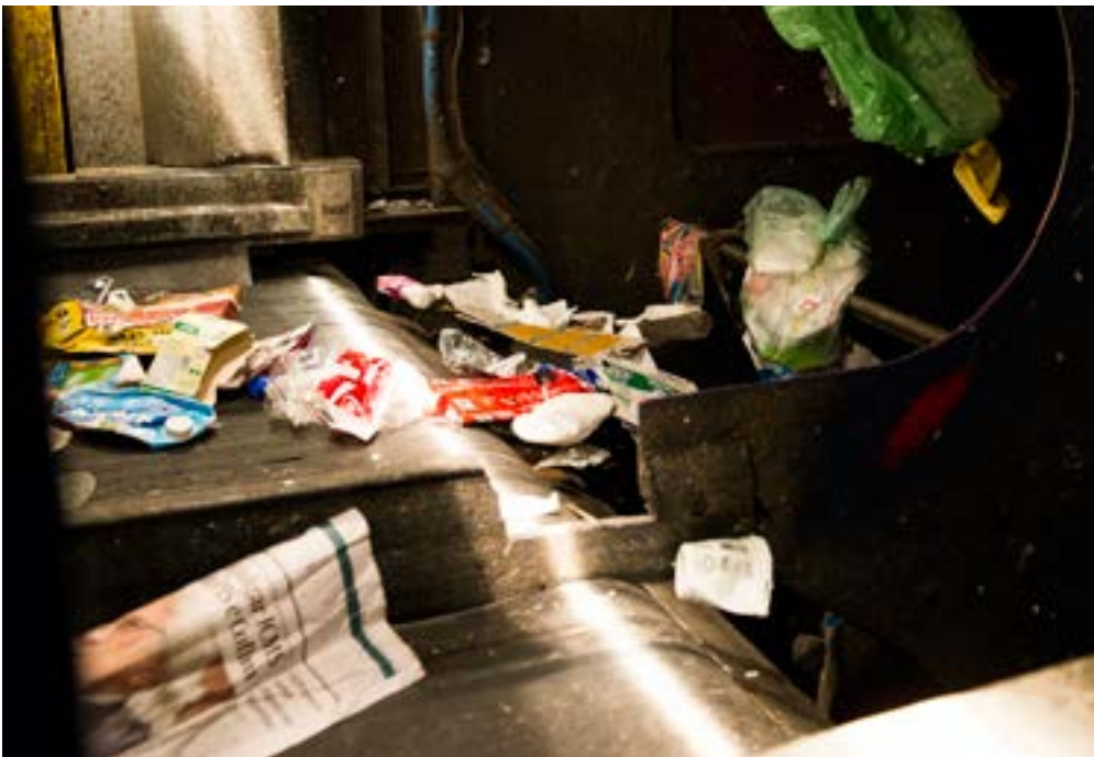
6 Plásticos passam por um sensor óptico que os separa por tipo.
