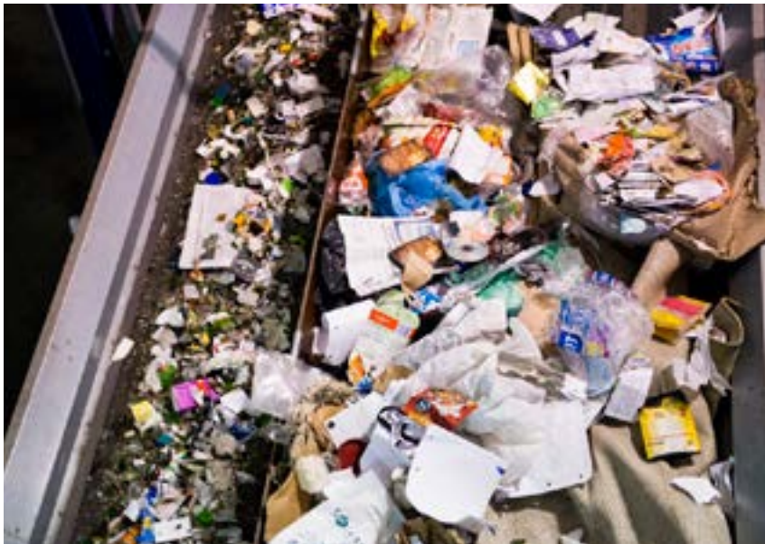
7 Lixo separado por sensor óptico que descarta os detritos que não podem ser aproveitados (à esquerda).
