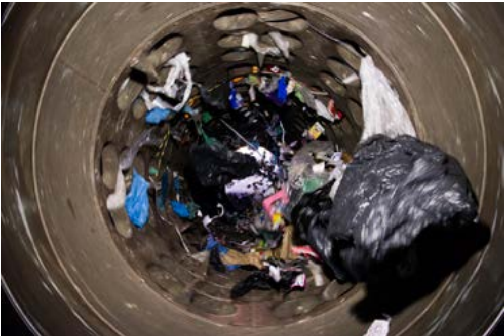
5 Material passa por um cilindro giratório que o separa por tamanhos, grande e pequeno.
