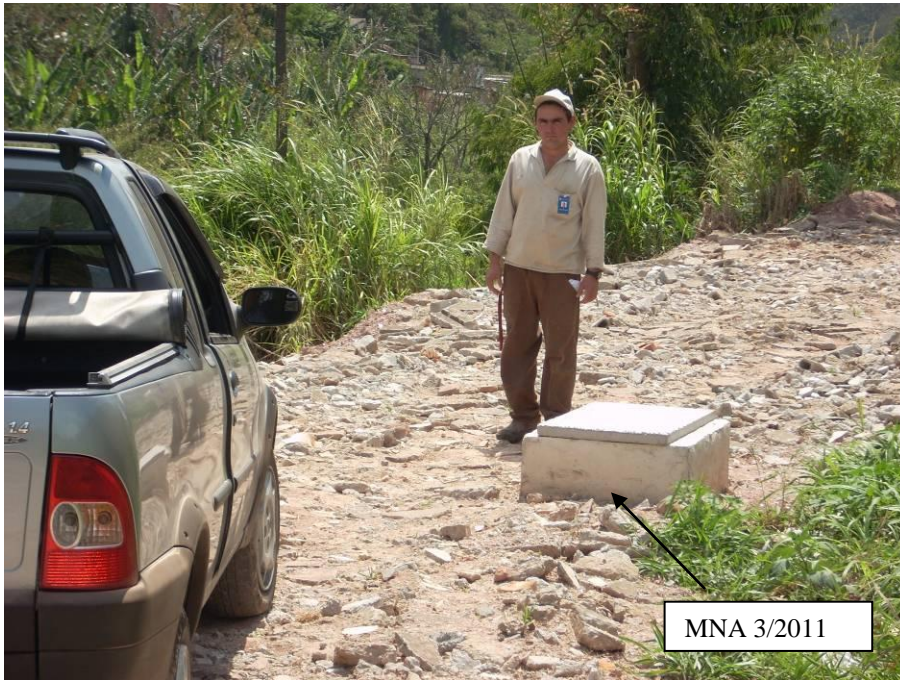
Foto 3.2.1.1-2 – Caixa de proteção de medidor de nível d'água (MNA-3/2011), instalado pela EMES Engenharia em 2011.
