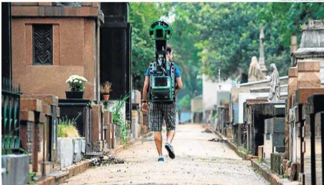
Tecnologia. Para captar imagens, empresa utilizou a Trekker, uma mochila com câmera
