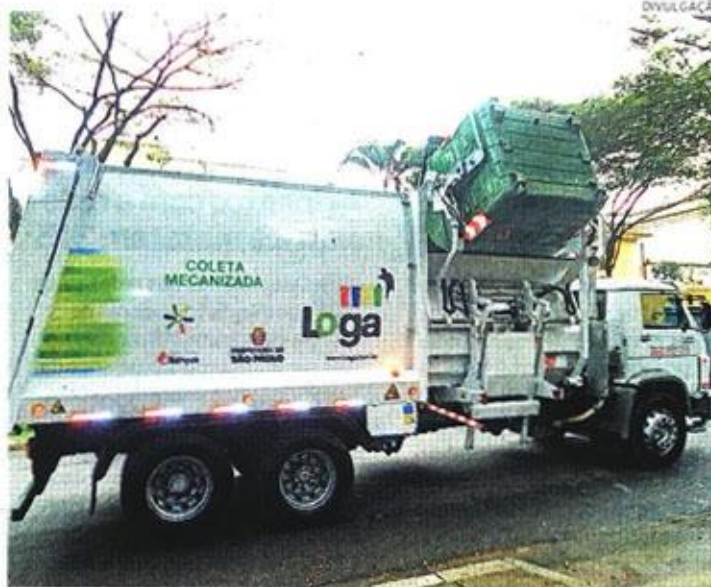
Caminhões com braços mecânicos fazem coleta do lixo do contêiner
