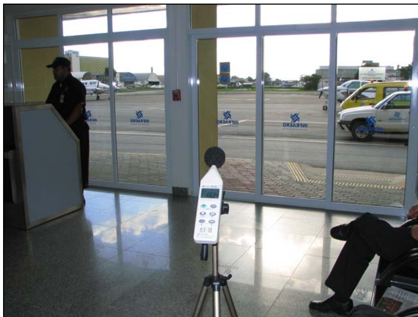
FIGURA 122 SETUP NO LOCAL, MOSTRANDO A CURTA DISTÂNCIA ENTRE A SALA E O PÁTIO DAS AERONAVES. AZIMUTE 256°V.
