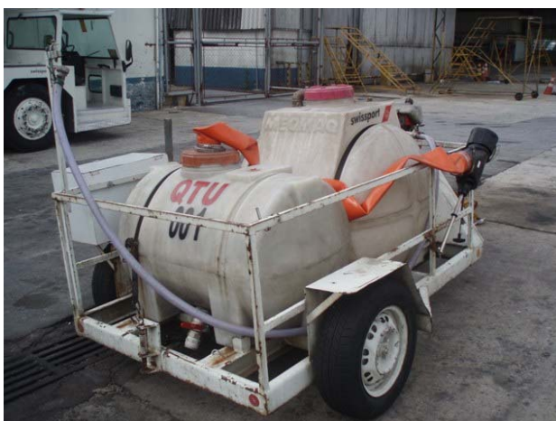
Figura 211: Equipamento coletor de esgoto sanitário das aeronaves. Fonte: VPC/Brasil, 2008.
