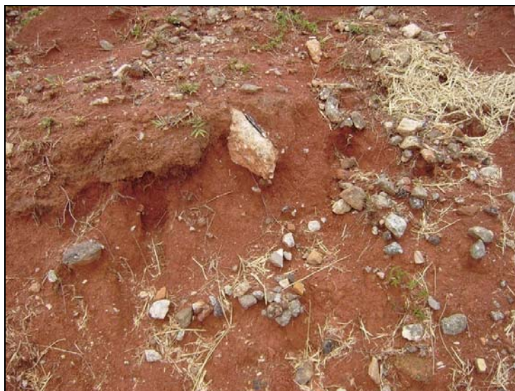
Figura 154: Fragmentos de rocha e concreto contidos na camada mais superficial do aterro da Cabeceira 17L. O fragmento maior, pouco acima do centro da fotografia é de concreto.
