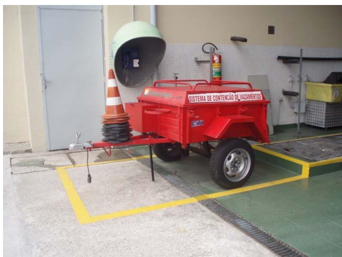
Figura 208: Existência de equipamento de atendimento a emergências ambientais, como derramamentos e pequenos vazamentos de combustíveis. Fonte: VPC/Brasil, 2008.
