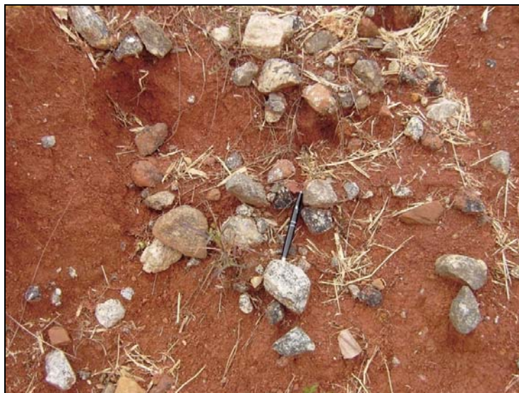
Figura 155: Fragmentos de rochas (gnaisse, granitos) e de concreto, na camada mais superficial do aterro da Cabeceira 17L.
