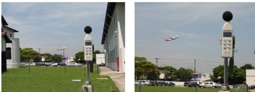
Figura 74: Setup no local mostrando a decolagem de dois Airbus 320 em ocasiões distintas. As diferenças de performance são evidentes entre as duas fotos. Azimute 210° V. Fonte: VPC/Brasil, 2008.
