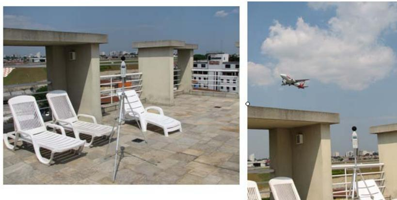
Figura 81: Setup azimute 113°V. Decolagem de Airbus 319. Fonte: VPC/Brasil, 2008.
