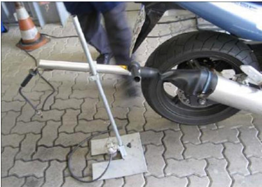
Figura I - Extensão com sonda móvel e coifa flexível
