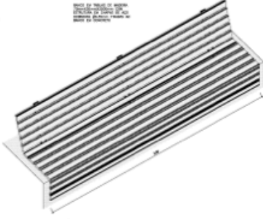
BANCO - ISOMÉTRICA ESCALA 1:10 O BANCO É FORMADO POR MÓDULOS DE 0,70m DE ALTEZURA TOTAL (0,40m DE CONCRETO + 0,30m DE MADEIRA). O MÓDULO DE 0,70m APRESENTA ANOSOS PARA O PISO DE PLÁSTICO, INCLINADO 2°.
